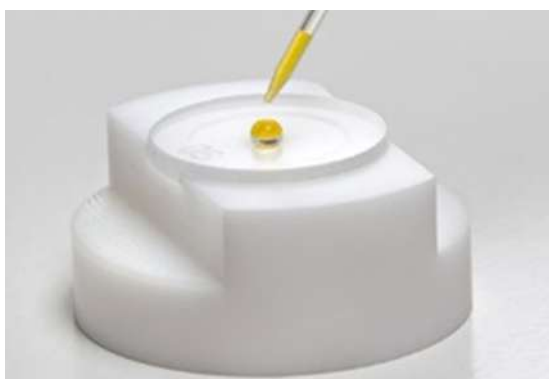
Kuva 2. Näytteen pipetointi mittauslevylle TXRF-mittauksessa. (Kuvan alkuperä: https://www.bruker.com/en/landingpages/bna/how-does-TXRF-work.html )
