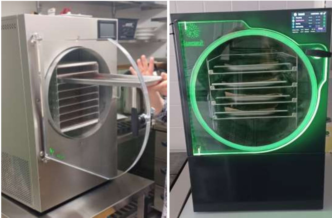
Kuva 30. Kylmäkuivauksessa tuotteet asetellaan kuivuriin tarjottimilla, jotka sijoitetaan kuivaushyllyille. Vasemmalla Harvest Right:n kuivuri Kajaanissa Kainuun ammattiopistolla ja oikealla Leosmakin kuivuri Itä-Suomen yliopistolla Kuopiossa. (Kuvat: Kaisa Rani-
