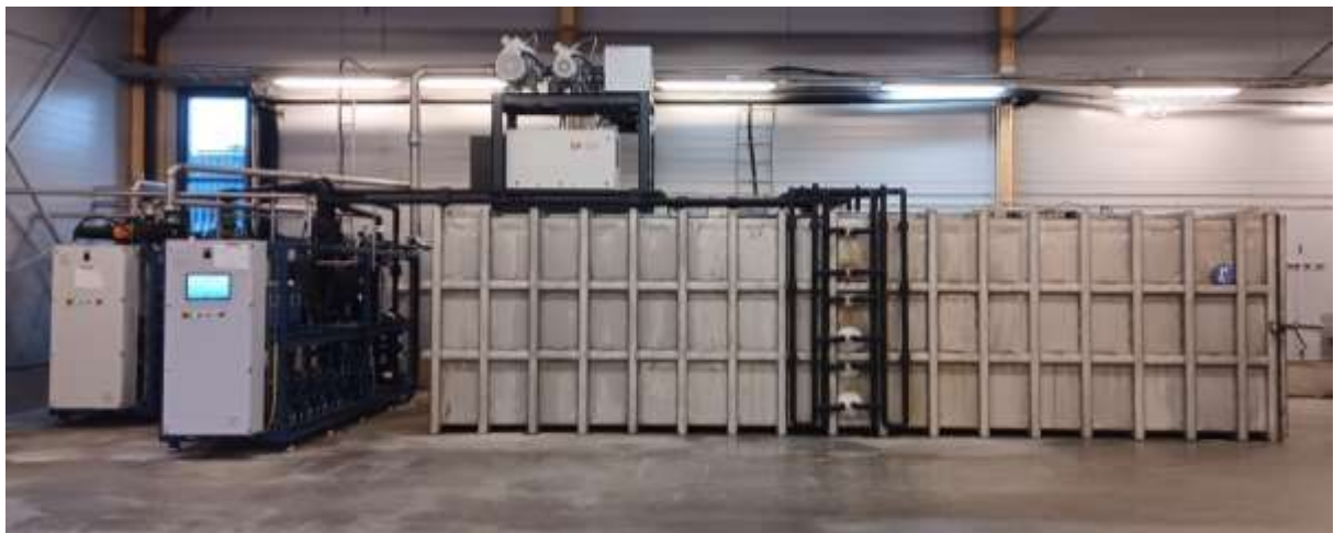
Kuva 36. FrostDry:n tekoälypohjainen kylmäkuivauslaitteisto Hirvensalmella. (Kuva: Kaisa Raninen)
