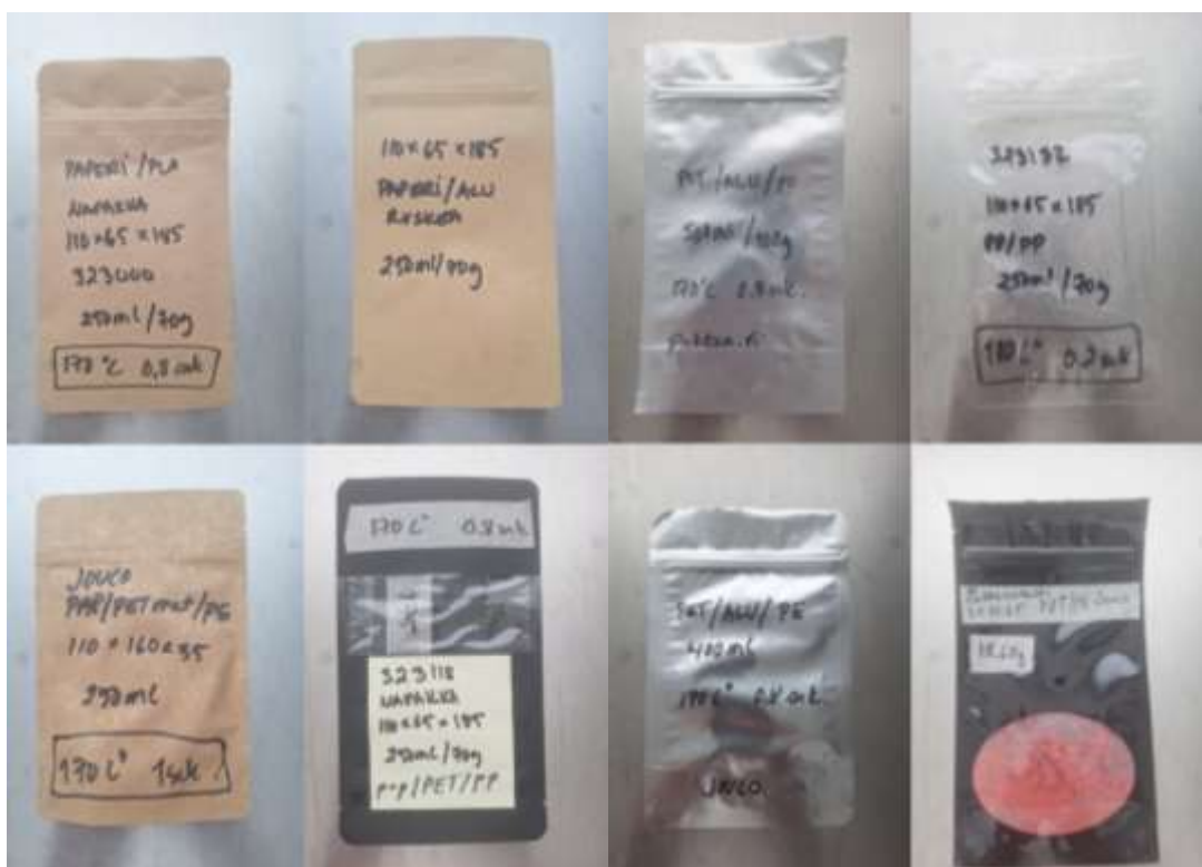
Kuva 35. Testatut doypack-pakkaukset. Pusseissa lukee niiden saamaamiseen käytetty lämpötila ja aika, PET/PE-pussista se puuttuu, sen saamaislämpö ja -aika oli 120 C°, 5 s. (Kuva: Jesse Ojala)
