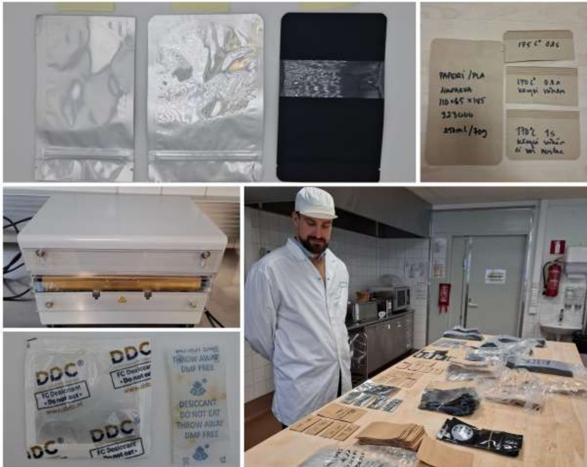
Kuva 34. Kylmäkuivattujen tuotteiden pakkaustestausta. Kuvissa erilaisia pakkauksia, kuumasaumain sekä pakkauksiin laitettavia kosteuden ja hapenpoistajia. (Kuvat: Jaana Kapustamäki)
