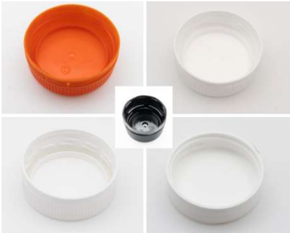
Kuva 11. Korkkeja HPP-testissä. Ylärivissä HPP-prosessissa hyvin toimineet sinettikorkilliset HDPE-korkit, jossa 35-kierre ja plug-tiiviste. Keskellä hyvin toiminut sinettikorkillinen PP-korkki ROPP 28/18-kaulaan sopivalla kierteellä. Alarivissä SP400-kierteellä oleva korkki ilman sinettiä ja tiivistettä sekä PLA-korkki, jotka eivät toimineet HPP-testissä. (Kuvat: Elina Välkky)
