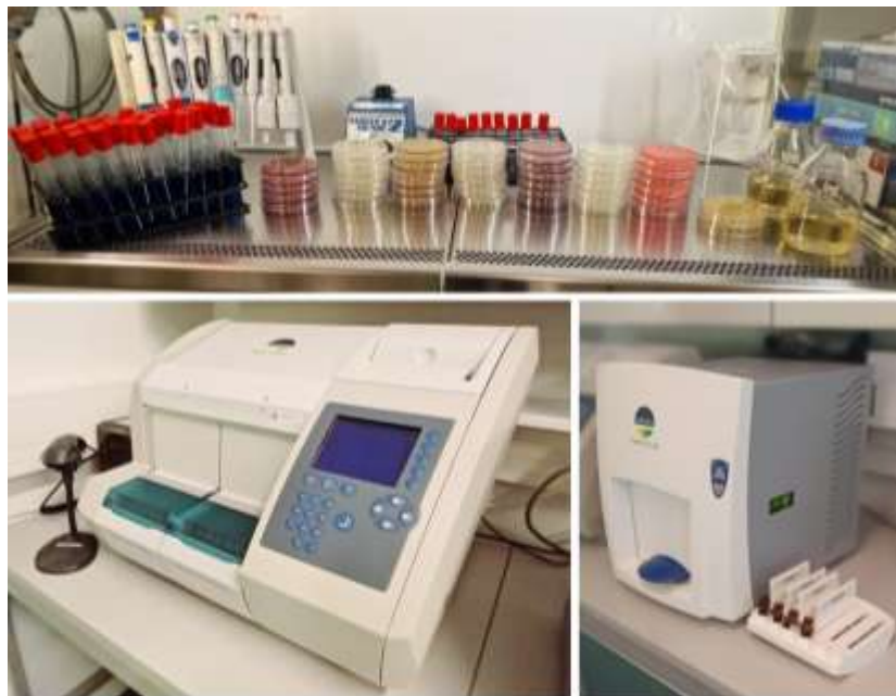
Kuva 43. Mikrobiologian menetelmiä. Ylhäällä perinteisiä malja- ja nesteviljelyvälineistöä, alhaalla vasemmalla miniVidas- ja oikealla Tempo-laitteistot.
