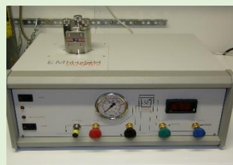
Kriittisen pisteen kuivauslaite Quorum Technologies K850
